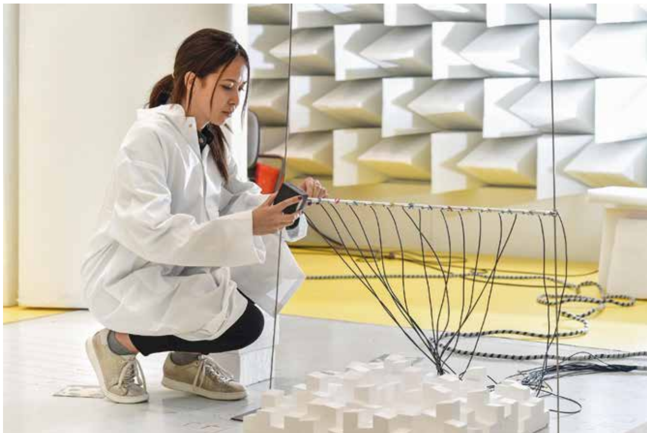
Etude du comportement acoustique de parois en vue d'améliorer la réduction du bruit dans les locaux de travail Copyright : Serge Morillon / INRS
