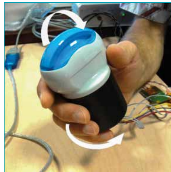
Sonde motorisée et sonde fictive : le transducteur peut être incliné et tourné (flèches) à distance en manipulant la sonde fictive (flèches)
